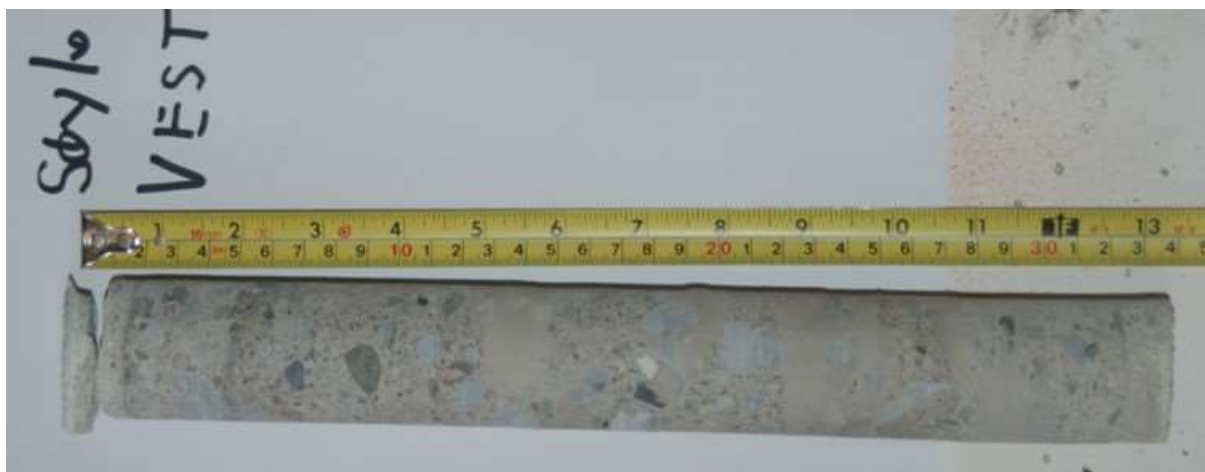
Bilde 13 Kjerne merket Søyle Vest. Kjernen er gjennomgående i søylen med puss i begge ender.
