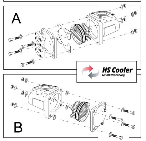
Aanvulling bij het hoofdstuk 'Onderhoud/demontage/ demontage zonder uittrekken van de buizenbundel'. Bij de montage moeten de fixeerplaten opnieuw aan de correcte zijde van de warmtewisselaar worden ingebouwd - zie ook de gebruiksaanwijzing!
