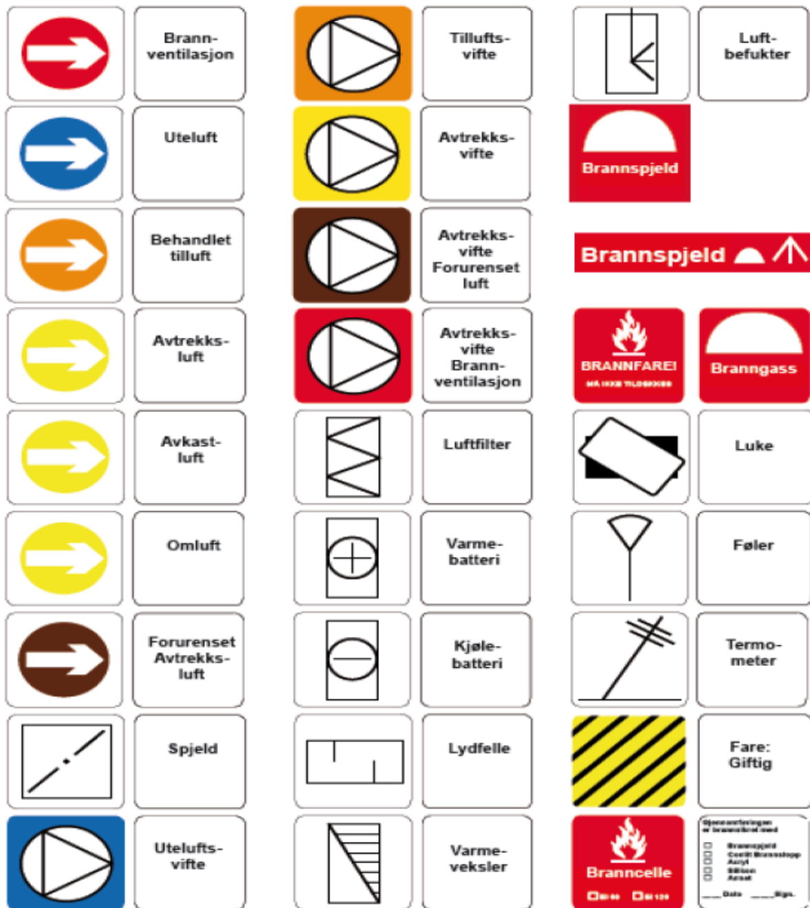
Figur 5-1 - Merking av ventilasjonsanlegg
