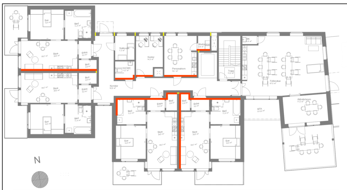
Figur 7: Forslag til påføringsvegger og vertikale sylomerer i plan 1. Påføringsvegger er vist med oransje farge, mens vertikale sylomerer er vist med gul farge.
