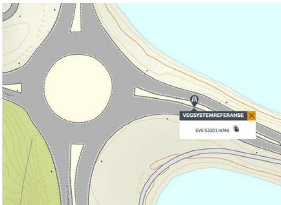
Figur 2: Grafisk fremstilling av en strekning innenfor et Vegsystem. Strekningsnummer er et unikt nummer for en strekning i et vegsystem for ERF-veger på landsbasis. F.eks. finnes S2 for EV6 kun et sted i landet. Delstrekkningsnummer deler opp strekningen etter vegens funksjon, f.eks. hovedløp, armer og gang- og sykkelveger. Normalt sett vil hovedløpet på vegen være delstrekning 1, mens delstrekkningsnummer for armer og gang- og sykkelveger tildeles fortløpende. Leksepelet har armen fått delstrekkningsnummer 10, og gang- og sykkelvegene delstrekkningsnummer 20, 30 og 40. Det er ingen fast regel for hvilket delstrekkningsnummer en arm eller en gang- og sykkelveg skal ha.
