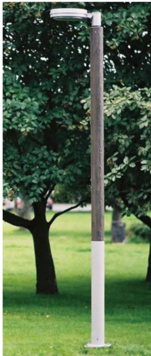
Lysmaster på parkeringsplass (5 stk) skal vere utført i laminert trevirke av seint veksande furu med høgt innhold av kjerneved fra nordisk trevirke. Nedste del av mastene skal vere av pulverlakkert stål (sjå bilde). Lysmastene skal vere koniske/sylinderiske og ha makshøgde på 6 meter. Armatur og base skal vere pulverlakkert i same gråfarge RAL 9007.
