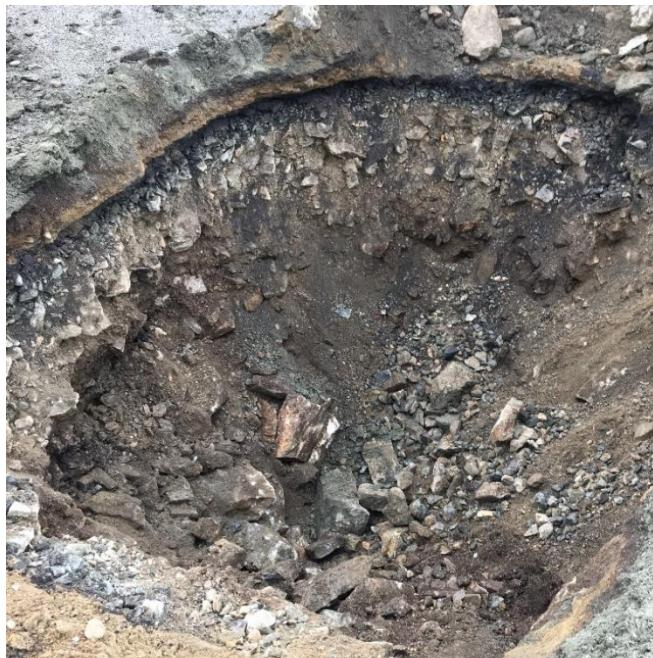
PG3 består også av tilnærmet lik lagdeling som PG1 og PG2. I denne prøvegropen ble stein-laget under det lysebrune laget observert med en mer svart farge, samt mer finstoff enn ved de tidligere prøvegropene. Det ble gravd til ca. 2 m dyp, men ikke påtruffet fjell. Det ble ikke observert grunnvann.
