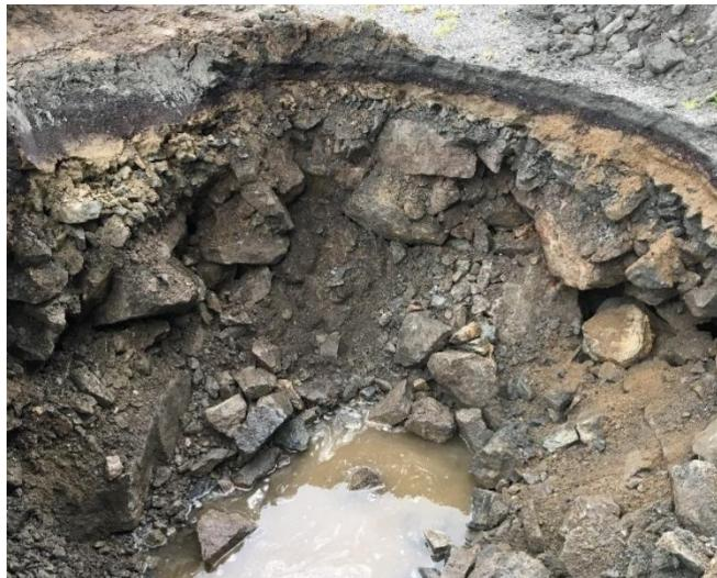
I PG2 ble det observert tilsvarende lagdeling som i PG1. Det ble gravd til ca. 2 m dyp, og det ble ikke påtruffet fjell. I denne prøvegropen ble det observert grunnvann ved ca. 1,8 m dyp. Det ble ikke observert olje-film på grunnvannet.
