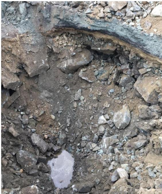
I PG5 ble det observert tilnærmet lik lagdeling som i PG1 og PG2. Det ble gravd til ca. 2 m dybde, med innitrenging av grunnvann i bunnen av prøvegropen. Det ble ikke observert olje-film på vannoverflaten.
