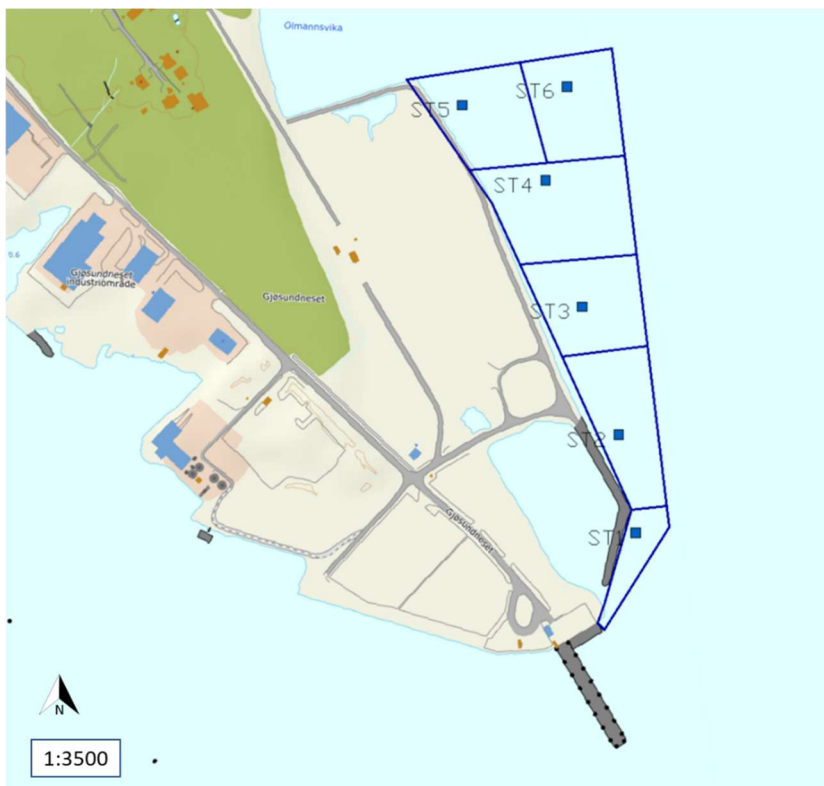
Figur 5 Prøvetakingsplan ved Gjøsdneset. Inndeling i blått viser arealet som dekkes av hver enkelt stasjon (S01-S06).
