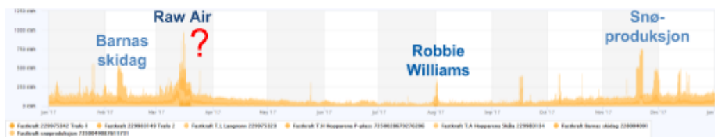
Figur 12: Forbruk og effekttopper i 2017 (Trondheim eiendom - Byggteknisk stab). Effekttoppene fordeler seg annerledes enn antatt på forhånd. Konserten har en relativt sett lavere topp enn forventet, mens snøproduksjon har en høyere topp. Raw Air ligger på topp som forventet.
